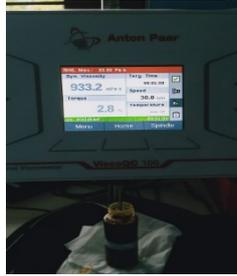
**Gambar 3.** Hasil Uji Viskositas
